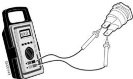
Après avoir débranché le connecteur, mesurer aux bornes du thermostat de sécurité:
