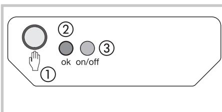
③ Témoin de fonctionnement. Ce voyant est allumé lorsque le contact de sortie du récepteur est fermé = ON.
