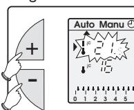
De indicator van het actuele temperatuurniveau (comfort of bezuiniging) gaat knipperen. Deze wijziging houdt op bij de volgende verandering van de geprogrammeerde temperatuur. Om naar het oorspronkelijk programma terug te keren drukt u op **MODE** en zet u de cursor **▲** terug onder **Auto**.
