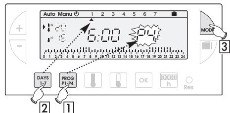
**1** Drücken Sie die Taste **PROG P1-P4** um in die Betriebsart Programmierung zu gelangen. Die Nummer des Programms, die dem Wochentag zugeordnet ist, blinkt im rechten Teildes Displays.
