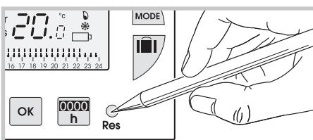
Il kit cronotermostato/ricevitore è stato concepito per apportare comfort ed economizzare energia. Si installa facilmente nella vostra casa, regola la temperatura ambiente in funzione della programmazione effettuata ed invia comandi marcia/arresto al ricevitore murale installato vicino alla caldaia.
