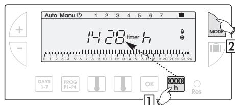
① Nachdem Sie die Taste **0000 h** gedrückt haben, wird Ihnen auf dem Display die Anzahl der Betriebsstunden seit dem Einsetzen der Batterien angezeigt, d.h. die Anzahl der Stunden, in denen Ihr Brenner, Ihre Klimaanlage, Ihr Heizlüfter oder ein anderes Gerät, das Sie angeschlossen haben, eingeschaltet war. (der Taste + oder - wird der Zähler auf Null gesetzt).
