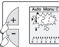
Die Anzeige des aktuellen Sollwertes der Temperatur (Absenk- oder Komforttemperatur) beginnt zu blinken. Diese Änderung wird mit dem nächsten programmierten Temperaturwechsel aufgehoben. Um zum ursprünglichen Programm zurückzukehren, ist die Taste **MODE** zu drücken, bis der Zeiger **▲** unter **Auto** steht.
