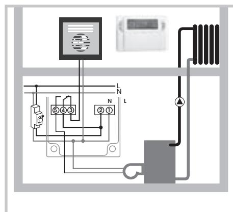
! Jestliže použijete termostat s hodinami pro řízení vytápění a chlazení, musíte mít na zřeteli, aby oba systémy (topení a chlazení) nebyly v provozu během stejného ročního období.
