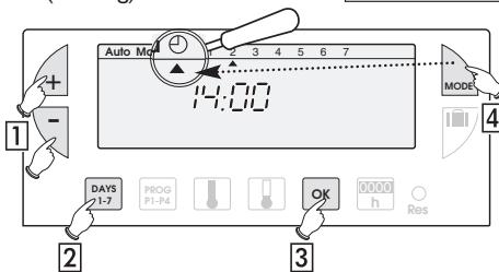
**1** Stellen Sie nun mit den Tasten **+/** die Uhrzeit ein. Beim anhaltenden Drücken dieser Tasten läuft die Zeitanzeige schneller durch.
