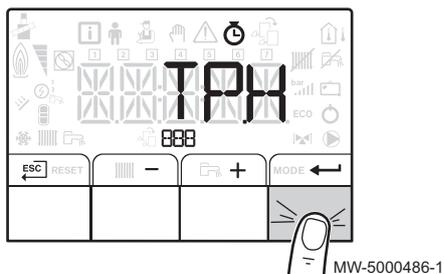
3. Valider la sélection en appuyant sur la touche ←. Sélectionner la programmation horaire pour le chauffage *TPH* ou la programmation horaire pour le rafraîchissement *TPC* en appuyant sur la touche + ou -.
