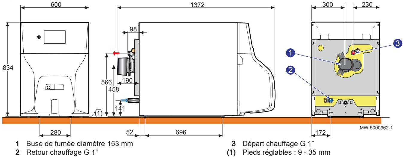
Fig.3 Chaudière seule CFU 46 F30
