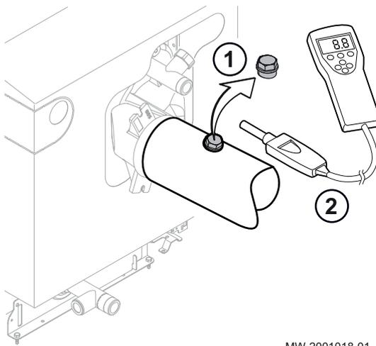
Contrôler la combustion en mesurant le pourcentage de O<sub>2</sub> (CO<sub>2</sub>) dans la conduite d'évacuation des fumées.
