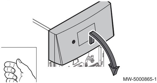
2. Décrocher et déposer le tableau de commande sur la chaudière.
