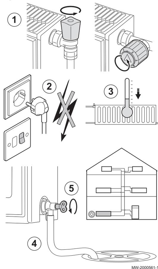
Une vidange du système de chauffage central peut s'avérer nécessaire en cas de remplacement des radiateurs, de fuite d'eau importante ou de risque de gel.
