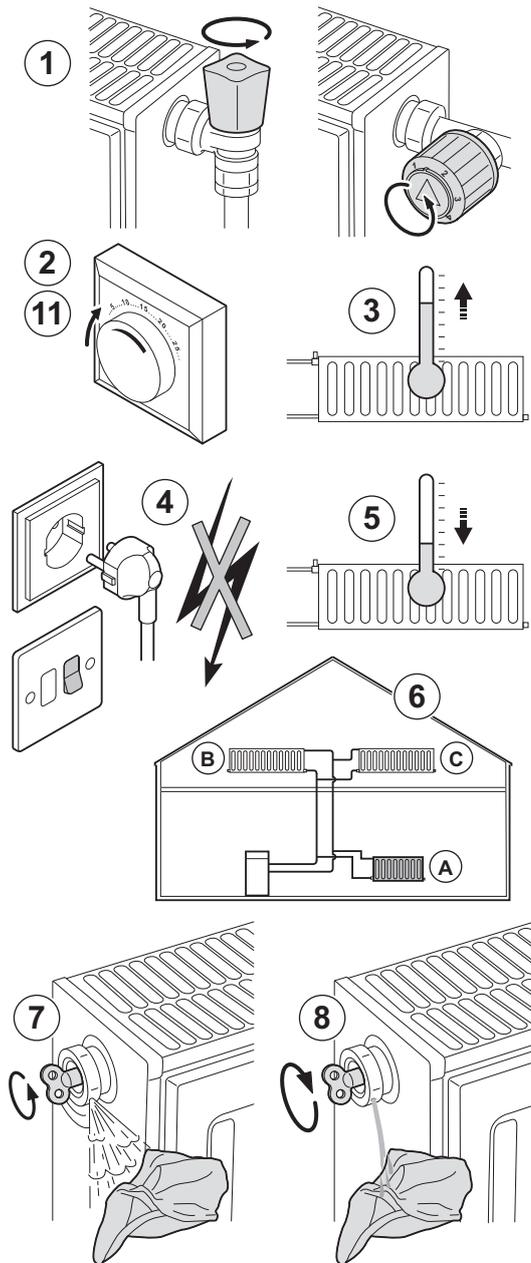
Il est indispensable de purger l'air éventuellement présent dans la chaudière, les conduits ou la robinetterie pour éviter les bruits indésirables susceptibles de se produire lors du chauffage ou du soutirage de l'eau.
