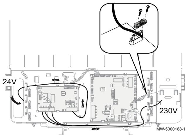
8. En cas de changement de carte électronique, fixer le (ou les) câble(s) à l'aide des arrêts de traction.
