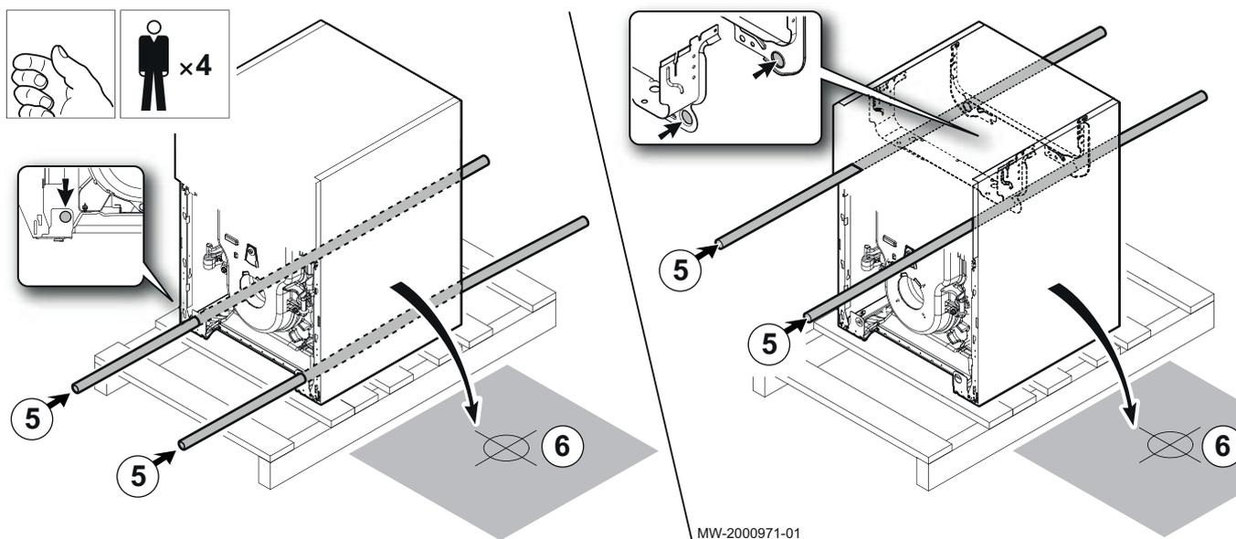
5. Descendre la chaudière de la palette de transport à l'aide de barres de levage. Utiliser des tubes en acier de diamètre 1/2" et de longueur 1400 mm.
