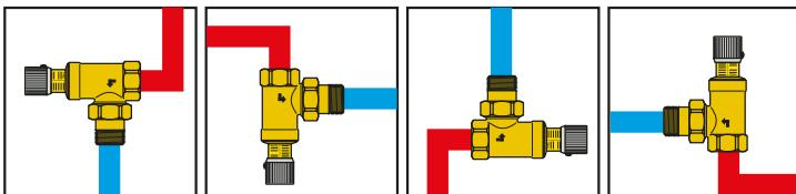
Il est possible de monter la vanne de by-pass différentielle dans n'importe quelle position du moment que l'on respecte le sens du flux indiqué par la flèche qui se trouve sur le corps de la vanne.
