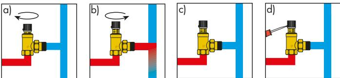
Pour régler la vanne, tourner le bouton sur la valeur choisie de l'échelle graduée : les valeurs correspondent à la pression différentielle d'ouverture du by-pass.
