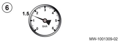
6. Vérifier la pression dans l'installation. Si la pression est inférieure à 1,5 bar, effectuer l'appoint en eau.
