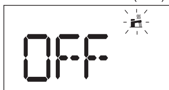
Fig.53 Désactivation de la production d'eau chaude sanitaire (ECS)
