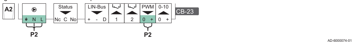
Fig.30 Raccordements électriques - Chaudière suiveuse A2
