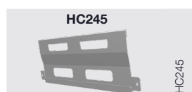
HC245 Rail de montage AMC sur un système cascade MC - Réf. : S101463 Ce rail s'accroche sur le châssis du système cascade existant (alignement au sol "LV" uniquement) et permet d'aligner la nouvelle chaudière AMC PRO EVO en bas avec les autres chaudières de la cascade et de la raccorder hydrauliquement sans modifier le kit existant.
