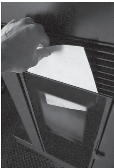
Fig.99 Vérification de l'étanchéité de la porte
