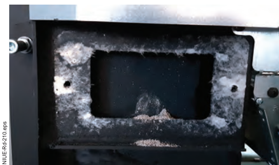
Fig.92 Le joint assure l'étanchéité de l'échangeur.
