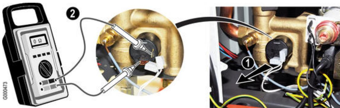
1. Mesurez la valeur ohmique aux bornes du pressostat :
