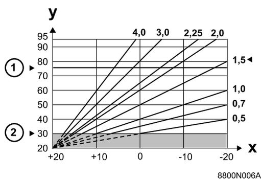
① Température maximale de la chaudière (réglage d'usine 75 °C)
