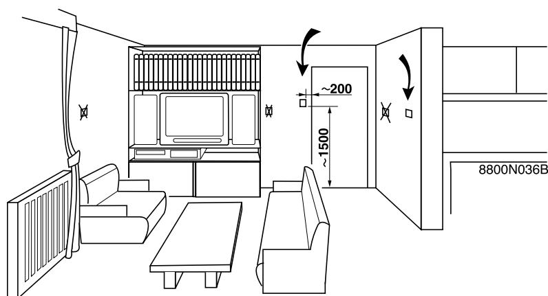
La commande à distance sera installée contre une cloison intérieure, à environ 1.5 m du sol dans la pièce pilote judicieusement choisie.
