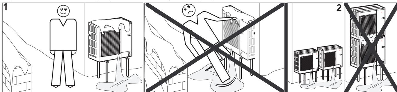
1. Toujours installer le groupe extérieur le plus loin possible du lieu de passage car l'évacuation des condensats pourrait geler et créer un danger (plaque de verglas).
