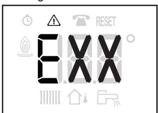
Fig.53 Affichage des codes de défauts
