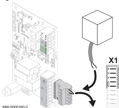
1. Raccorder le thermostat de sécurité sur l'entrée **X1 TS** de la carte électronique optionnelle **SCB-04**.
