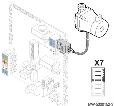
1. Raccorder la pompe de charge sanitaire sur l'entrée X7 de la carte électronique CU-OH04.
