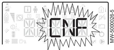
6. Sélectionner le paramètre **CNF** correspondant à la réinitialisation du tableau de commande en appuyant sur les touches **+** et **-**.
