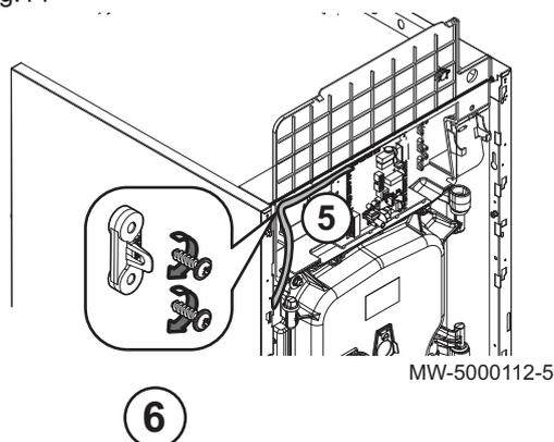
4. Mettre en place le serre-câbles à l'aide des vis cruciformes (pièces fournies dans le sachet du tableau de commande).
