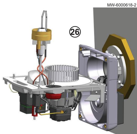
26. Nettoyer le ventilateur et l'intérieur du boîtier d'aspiration à l'aide d'une brosse adaptée et de l'air comprimé.
