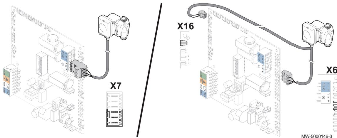
1. Raccorder la pompe chauffage du circuit direct en fonction du type et de la configuration de l'installation.
