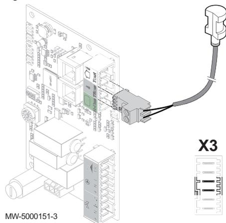
1. Raccorder la sonde de température sur l'entrée **X3 S DEP** de la carte électronique optionnelle **SCB-04**.
