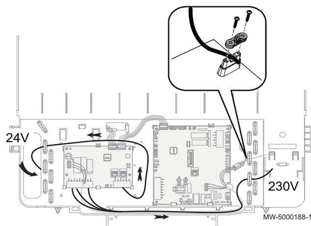
10. Fixer le (ou les) câble(s) à l'aide des arrêts de traction.
