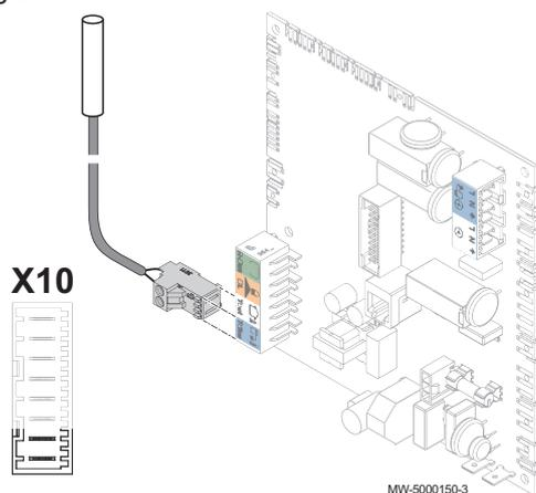
1. Raccorder la sonde de température eau chaude sanitaire sur l'entrée **Tdhw** de la carte électronique **CU-OH04**.
