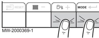
Appuyer sur n'importe quelle touche pour allumer le rétro-éclairage de l'écran du tableau de commande.
