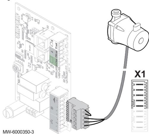
1. Raccorder la pompe chauffage du circuit mélangé sur l'entrée X1 de la carte électronique optionnelle SCB-04.
