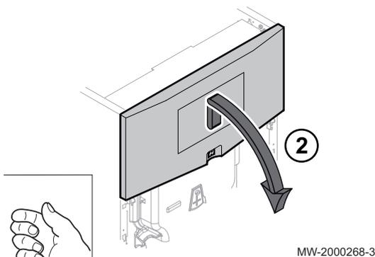
2. Décrocher et déposer le panneau avant supérieur sur la chaudière.
