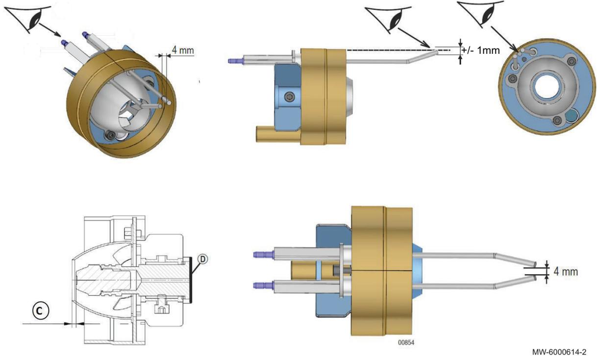
1. Vérifier la position des électrodes d'allumage.
