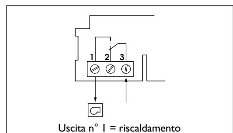
Se la caldaia ha un'entrata termostato sopprimere il deviatore che collega i 2 morsetti termostato e raccordare i morsetti 1 e 3 del cronotermostato digitale programmabile ai 2 morsetti di entrata termostato della caldaia (il senso di raccordo è indifferente).
