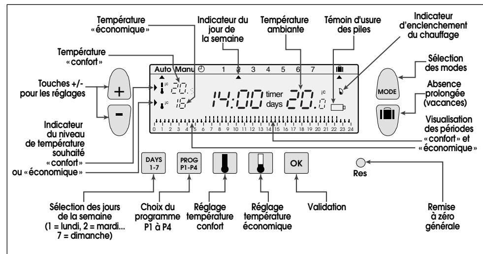
Ce thermostat programmable a été conçu pour vous apporter confort et économie d'énergie. Il permet de programmer et de réguler votre chauffage selon 3 niveaux de température :
