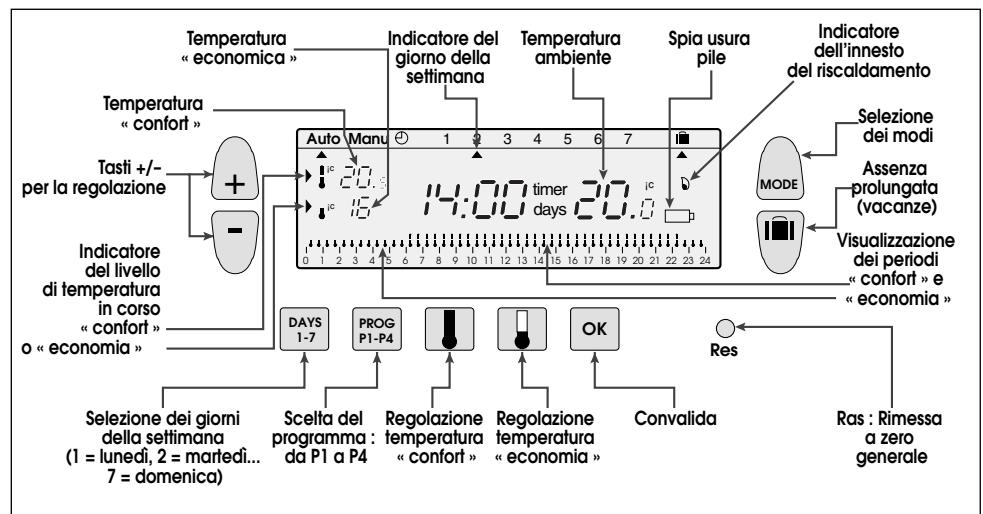
Il cronotermostato digitale programmatico è stato creato per apportare conforto ed economizzare energia e permette di programmare e di regolare il riscaldamento o il sistema di aria condizionamento secondo 3 livelli di temperatura:
