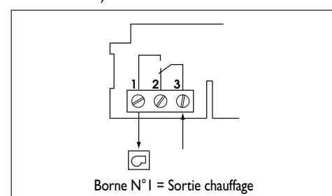
Si votre chaudière possède une entrée thermostat, supprimez le pontage reliant les 2 bornes thermostat et raccordez les bornes 1 et 3 de votre thermostat programmable aux 2 bornes d'entrée thermostat de la chaudière (le sens de raccordement est indifférent).
