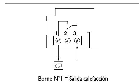
Si su caldera posee una entrada termostato, saque la resistencia entre los bornes para el termostato y conecte los bornes 1 y 3 de su termostato a los dos bornes de entrada termostato de la caldera (el sentido de la conexión es indiferente).
