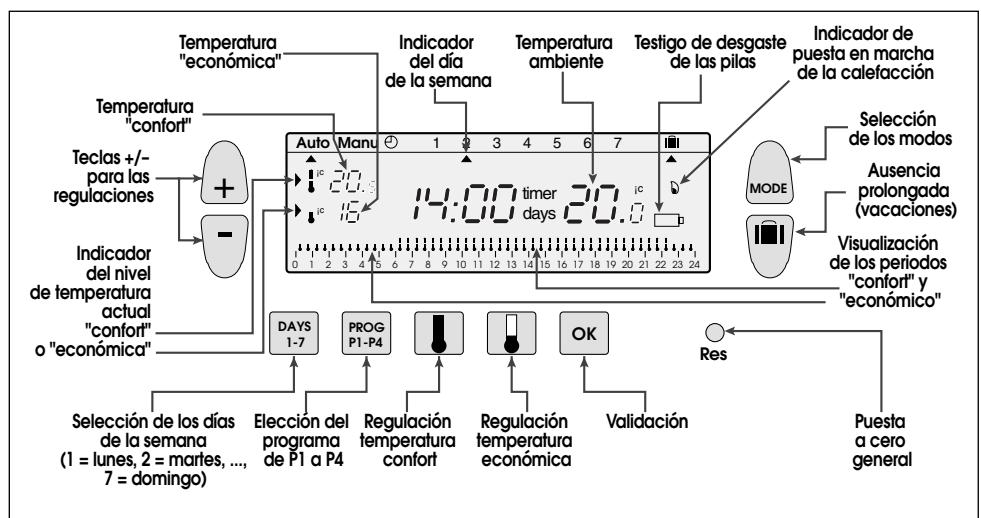
El termostato ha sido diseñado para proporcionarle confort y permitirle ahorrar energía. Puede programar y regular su calefacción o climatización según tres niveles de temperatura:
