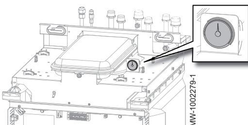
1. Remplir l'installation jusqu'à atteindre une pression comprise entre 1,5 et 2 bar. Lire la pression sur le manomètre mécanique.
