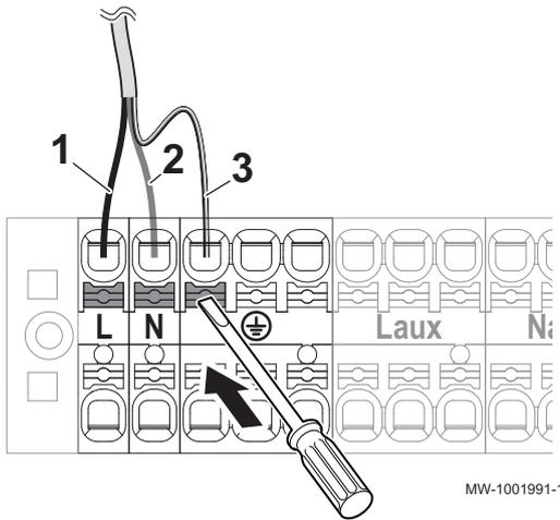
2. Brancher le câble sur le bornier comme indiqué sur la figure. Appuyer sur le bouton poussoir pour pouvoir insérer correctement le fil dans le connecteur et le bloquer.
