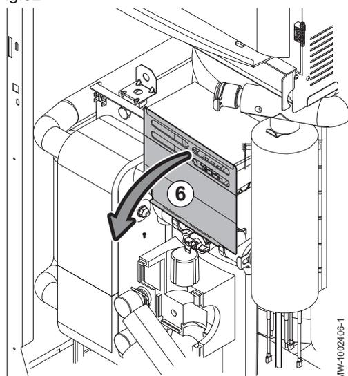
6. Accéder aux borniers pour le raccordement de la résistance électrique : appuyer sur le volet de protection vers le bas pour le retirer.
