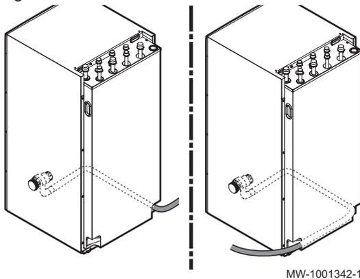
1. Raccorder le conduit d'écoulement à l'évacuation des eaux usées.
