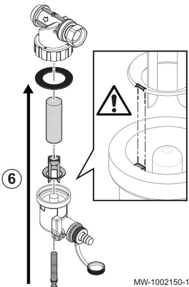
6. Remonter le filtre en respectant les détrompeurs de la pièce plastique.
