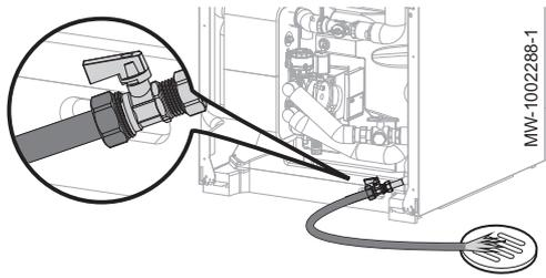
1. Rincer l'intégralité du circuit sanitaire, dont le préparateur d'eau chaude sanitaire, avec au moins 20 fois son volume d'eau conformément à la norme NF DTU 60.1. Utiliser le robinet de vidange de l'appareil.
