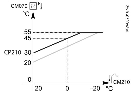
Avec un réglage de la **température du pied de la courbe** (CP210 / CP220 > 15 °C) à 30 °C : une **température extérieure** CM210 de 0 °C donnera une **consigne de température de départ du circuit** CM070 de 45 °C.
