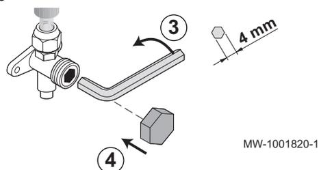
3. Ouvrir la vanne de la ligne gaz avec une clé hexagonale en tournant dans le sens contraire des aiguilles d'une montre jusqu'à la butée.
