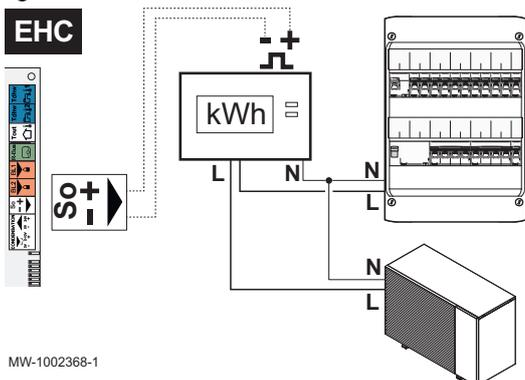
Raccorder un compteur d'énergie sur l'alimentation du groupe extérieur permet d'indiquer à la pompe à chaleur la mesure exacte de l'énergie électrique consommée sur celui-ci.
