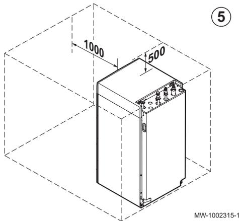
3. Installer obligatoirement les accessoires dans le module intérieur avant de le placer contre des murs. Prévoir un espace suffisant autour du module intérieur. Ne pas installer le module intérieur dans un placard.
