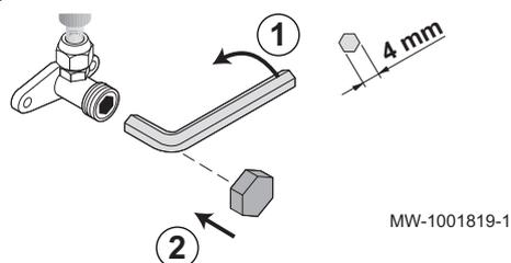
1. Ouvrir la vanne de la ligne liquide avec une clé hexagonale en tournant dans le sens contraire des aiguilles d'une montre jusqu'à la butée.
