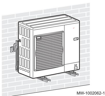
Pour des raisons d'entretien et de vibrations, il est préférable de placer le groupe extérieur sur un sol ferme. Cependant, il est également possible de fixer le groupe extérieur sur des supports muraux.
