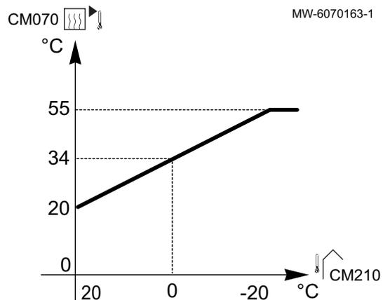
Sans un réglage de la **température du pied de la courbe** (CP210 / CP220 réglé sur 15 °C) : une **température extérieure** CM210 de 0 °C donnera une **consigne de température de départ du circuit** CM070 de 34 °C.
