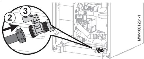
1. Fermer le robinet d'arrivée d'eau de l'installation.
