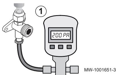
Effectuer le tirage au vide après avoir vérifié qu'il n'y a pas de fuite sur l'ensemble du circuit frigorifique. Le tirage au vide est nécessaire pour enlever l'air et l'humidité du circuit frigorifique.
