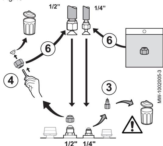
1. Retirer le bouchon de la valve Schrader.
