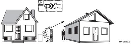
1. Placer l'écran anti-bruit le plus près possible de la source sonore tout en permettant la libre circulation de l'air dans l'échangeur du groupe extérieur et les interventions d'entretien.
