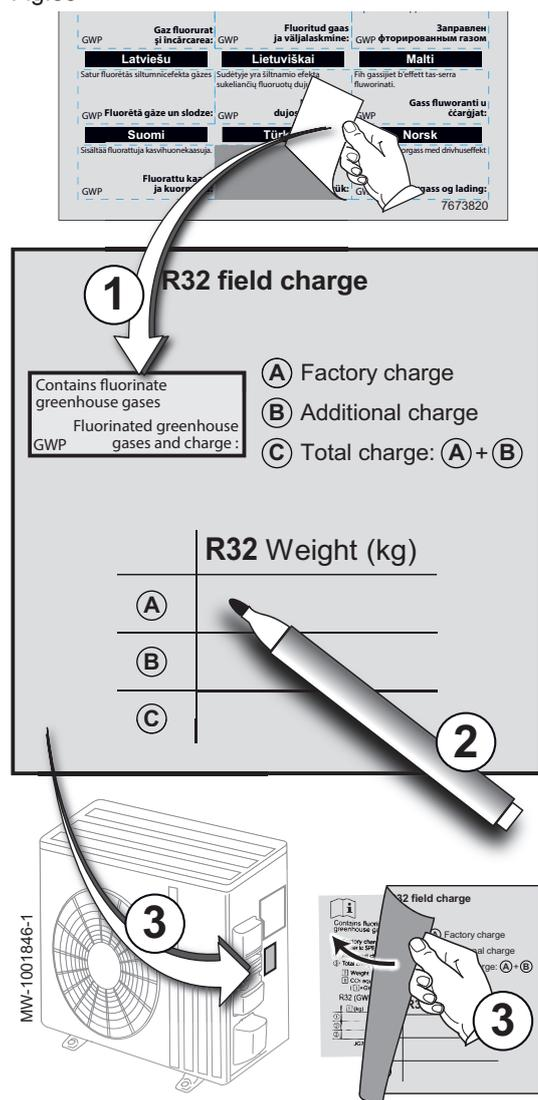
La réglementation européenne F-Gas N°517/2014 impose le marquage indélébile sur l'appareil de certaines mentions comme le nom chimique du fluide frigorigène et la quantité de fluide frigorigène présente dans le circuit frigorifique. Pour cela, utiliser les autocollants fournis avec le module intérieur.
