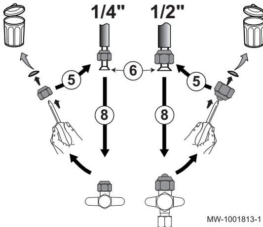
5. Utiliser les écrous présents sur l'appareil pour les enfiler sur les tubes frigorifiques, mettre leurs joints au rebut.
