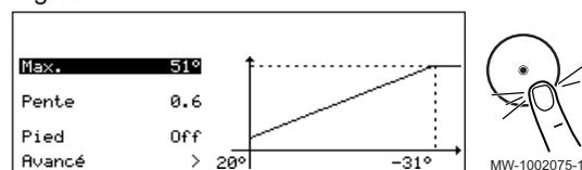
La courbe de chauffe se règle au moment de la mise en service de l'installation, vannes thermostatiques ouvertes si nécessaire. En cas de déperdition importante du bâtiment il est nécessaire d'ajuster la pente de la courbe à mi-saison puis en plein hiver par palier de 0,1 toutes les 24 heures (inertie du bâtiment).
