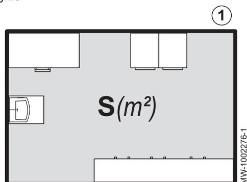
1. Déterminer la surface minimale au sol **S (m<sup>2</sup>)** non occupée nécessaire pour l'installation.
