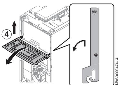
4. Accéder à l'interface utilisateur : soulever le support du module de régulation, le faire basculer et l'accrocher en position horizontale.
