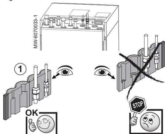
1. Positionner la coque de protection sur les raccords frigorifiques.
