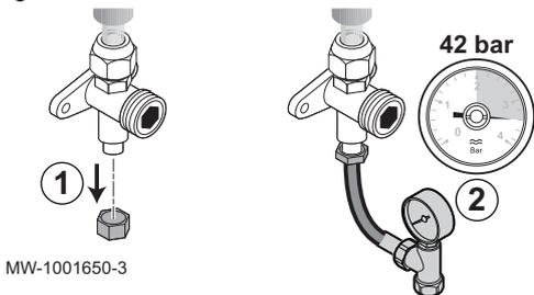
1. Retirer le bouchon du raccord de service de la vanne d'arrêt.
