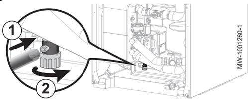
1. Brancher un flexible adapté (diamètre intérieur : 8 mm) sur le robinet de vidange du circuit de chauffage.
