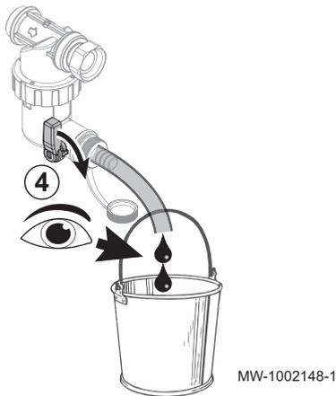
4. Ouvrir progressivement le robinet, laisser l'eau s'écouler jusqu'à élimination des boues ou jusqu'à vidange complète : l'eau doit être claire et transparente. Refermer le robinet. Si nécessaire, ouvrir et fermer plusieurs fois le robinet pour créer des à-coups et mieux nettoyer le filtre.
