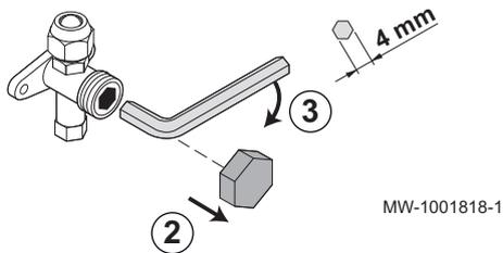
2. Retirer les bouchons des vannes d'arrêt.
