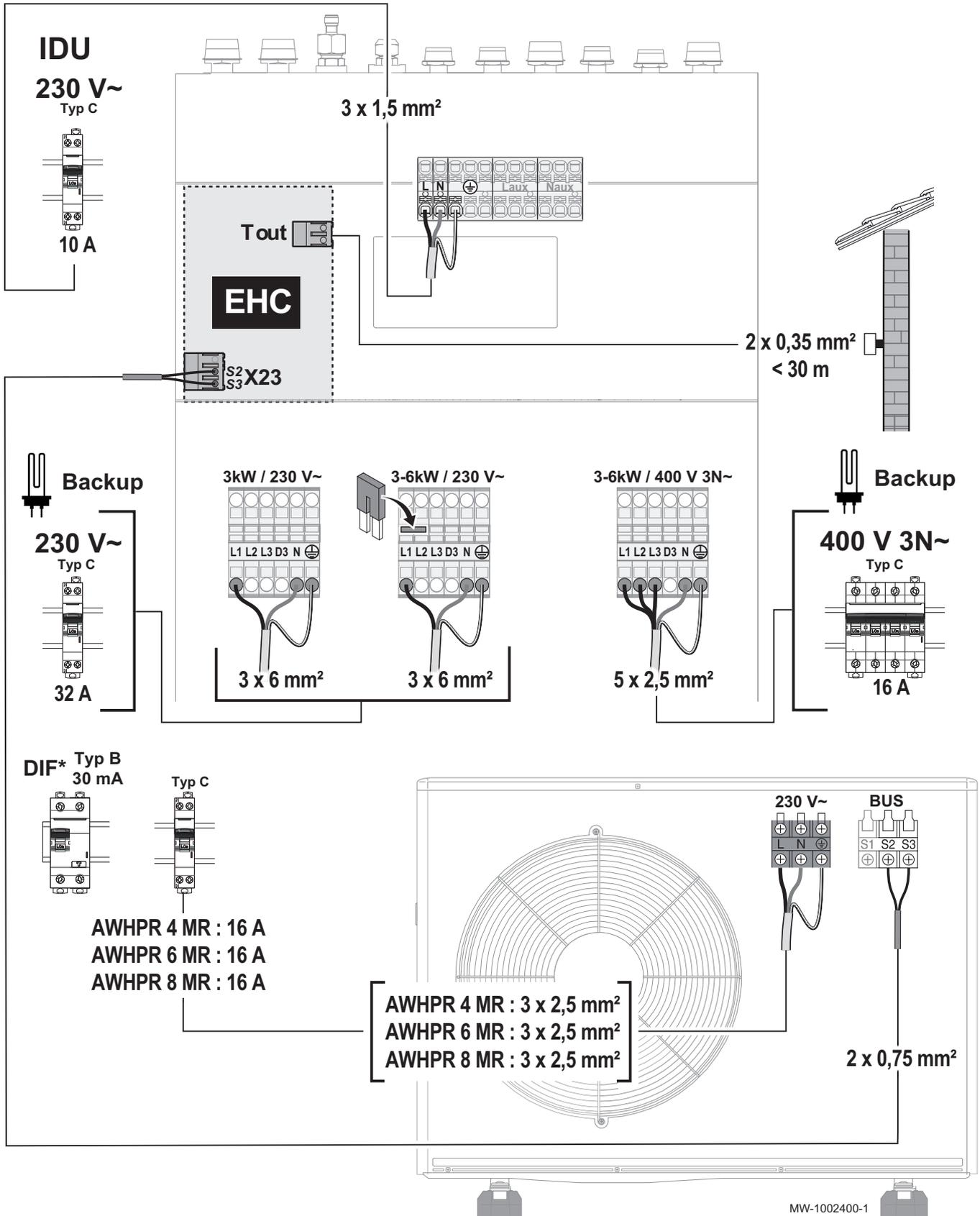
**Backup** Bornier de connexion pour la résistance électrique
