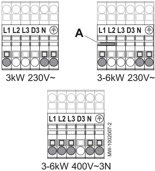
3. Raccorder l'alimentation et mettre en place le pont A si nécessaire. Il est possible de raccorder l'appoint sur une des 3 phases d'une installation triphasée, si nécessaire.
